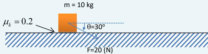
圖 7-5 物體受外力做功並抵消摩擦力所作的功。
