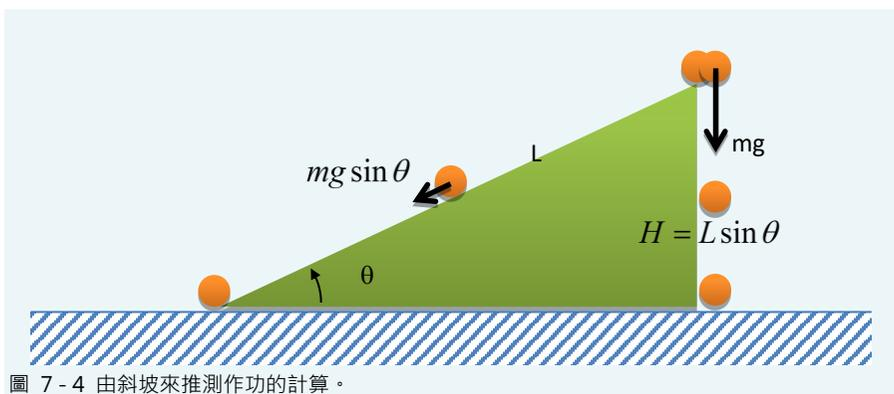
圖 7-4 由斜坡來推測作功的計算。
