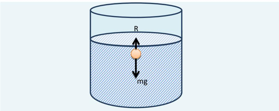
圖 6-10 物體在液體中自由落下示意圖。
