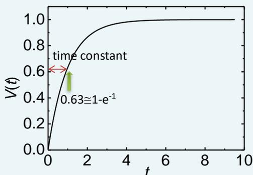
圖 6-11 物體在液體中自由落體之速度隨時間變化圖。
