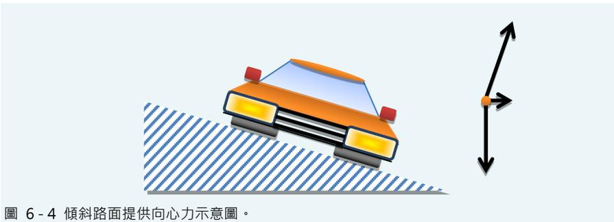
圖 6-4 傾斜路面提供向心力示意圖。
