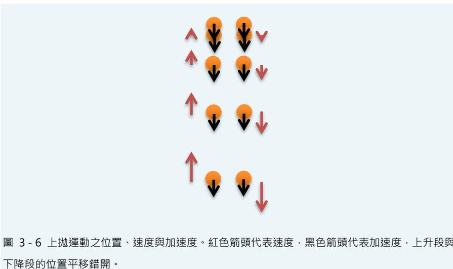
圖 3-6 上拋運動之位置、速度與加速度。紅色箭頭代表速度，黑色箭頭代表加速度，上升段與下降段的位置平移錯開。
