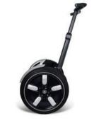
正如你的大腦,賽格威知道你正向前傾時,它會運用適當的速度 轉動輪子,所以車子就會向前行,賽格威最基本的組合,是一系 列的感應器,控制系統及馬達系統,在本段說明,我們來看一下 每個部份的元件基本感應系統是一組陀螺儀組合,基本的陀螺儀 有如置於穩定設計裝置的輪脊。
